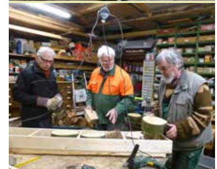
Bau der „Hoteleinrichtung“ (von oben): Vorgefertigte, passgenaue Kästen, Holzstücke und Baumscheiben werden mit Hunderten von Löchern versehen und in die Kästen eingefügt.
