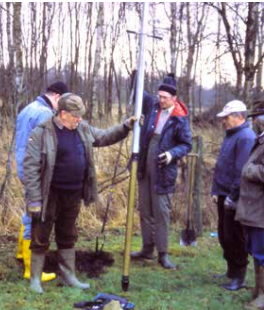
AKN-Gruppe beim Setzen eines der vier Rammpegel im Everstorfer Moor 2001.
